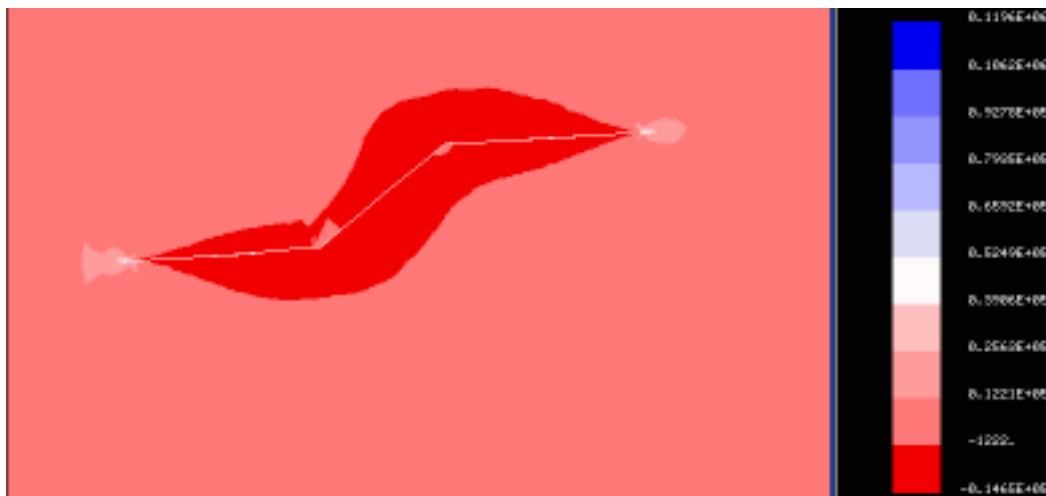
图 4.18 裂纹自动扩展后的 \sigma_x 应力云图
