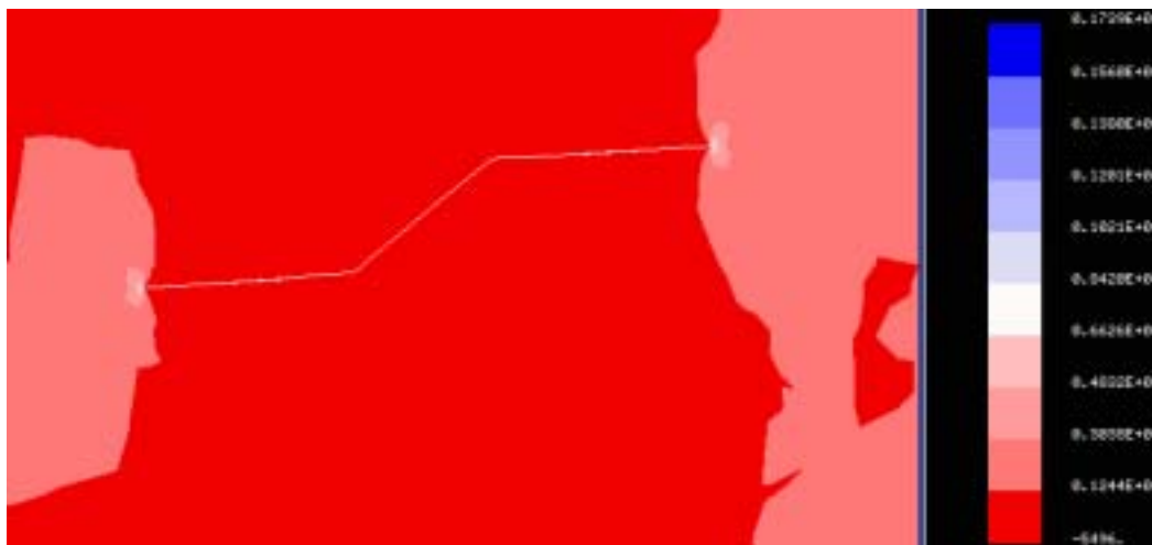
图 4.19 裂纹自动扩展后的 \sigma_y 应力云图
