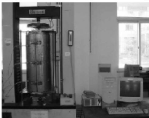
图 3.1 拉伸试验加热电炉
