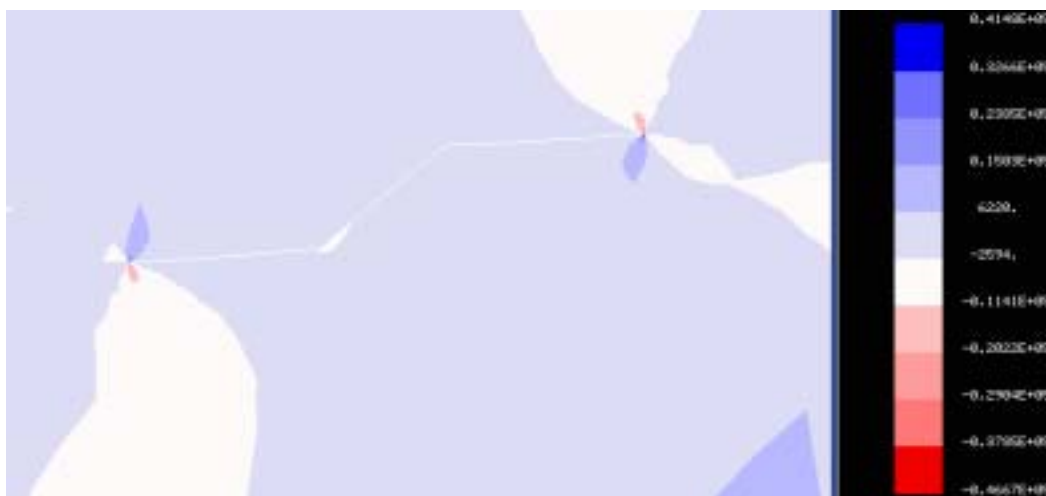
图 4.20 裂纹自动扩展后的 \sigma_{xy} 应力云图
