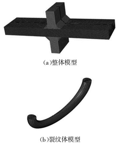
图 5 ABAQUS 中含裂纹体的有限元模型
